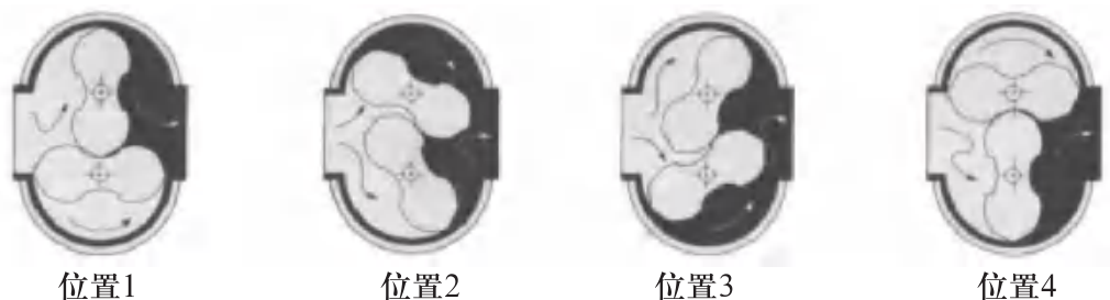
图2 气体腰轮流量计工作原理
