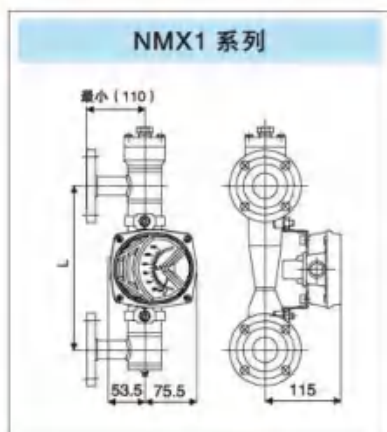
底侧(或底后侧)→顶侧(或顶后侧)外形图
