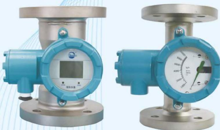
NMX2000系列金属管转子流量计常用于测量液体、气体和蒸汽流量，针对腐蚀性介质还可以提供内衬PTFE材质或其它特殊材质。仪表基本高度为250mm，便于配管设计，互换性强。除就地指示外，还具有开关信号输出，4~20mADC电流输出、HART通讯协议功能及LCD（带背光）显示累积流量等。由于结构简单、维护方便、工作可靠、压力损失小、对直管段基本无要求等优点，被广泛应用于石油、化工、冶金、纺织印染、环保、电力等工业领域。
