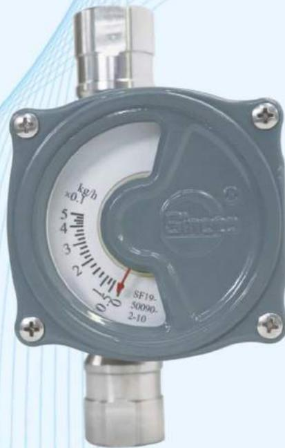
MA-900系列金属管转子流量计，适用于测量小流量的液体和气体。测量介质的某一流量，对应磁性浮子在测量管中的一个浮子位置，这个浮子位置通过指示器中的磁钢耦合给指针，由刻度盘和指针读出相应的流量值。
