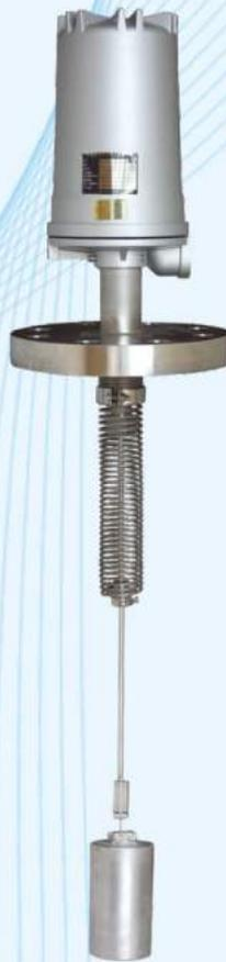
FS-100系列是一种弹簧平衡浮子式液位开关，其结构合理、可靠性高，是一种能应用于高温和高压场所的多点液位控制器，适用于石油、化工、纺织和印染、环保、电力等行业的各种容器的液位控制、报警、故障连锁等。受压部分和触点开关通过磁耦合系统实现完全隔离，同其它机械密封相比，具有更高的安全性和耐久性。新型的真空密封型开关能用于更苛刻的场合。
