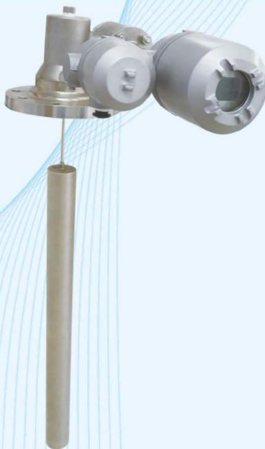
FST-3000系列智能型扭矩管式浮筒液位（界面）计是一种具有智能数据处理功能的仪表。先进的信号处理单元提供了测量过程变量、4mA ~ 20mA DC标准电流信号输出。采用液晶显示器（LCD）。智能信号处理单元具有线性化处理、测量误差自动补偿、HART通讯、自诊断等功能。仪表用来测量液位、界面或密度，并以极高的精确度和稳定性保证可靠的测量。仪表内的防爆型内置键盘能够在危险区域现场调整仪表参数。本系列产品备有多种材质可选，结构形式有防护型、隔爆型和本安型，可广泛应用于石油、化工、冶金、电力、食品、造纸、环保等工业领域。
