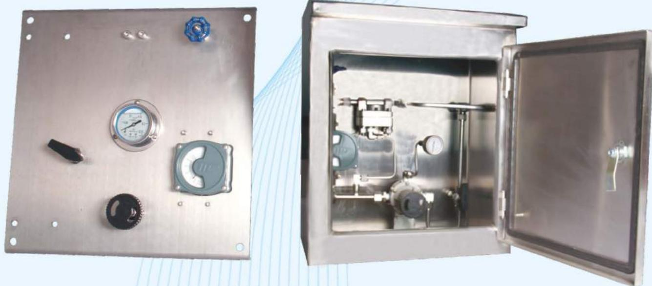
CMP20系列测压吹扫装置，集自动防堵吹扫、测压和清理功能于一体。一般应用于工况下，压力不稳定的场所。能通过恒流量调节阀的自动控制，使测压表（压力变送器），真实反映负载压力值。实现复杂工况下压力自动监控和防堵清理。广泛应用于锅炉、烟道及防液体结晶的场所。
