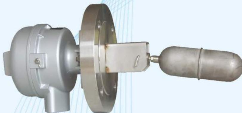
FB-7000系列浮球式液位开关结构合理，可靠性高，能用于难于对付的高温和高压场所，适用于工业生产过程敞开或承压容器内的液位控制、报警、故障连锁等。液位开关安装于容器罐壁，浮球跟踪液位，在液位到达设定点时，通过磁耦合使微动开关动作，实现液位高限或低限时的报警与控制。这种微动开关触点能够安全和有效地用来驱动蜂鸣器、灯或控制泵和阀门。广泛应用于石油、化工、环保、电力、冶金等工业领域。
