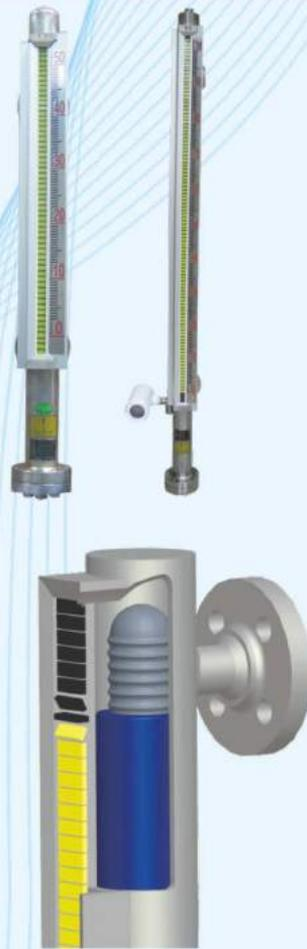
FM系列磁翻板液位计的液位指示采用清晰可视、带颜色的翻板，克服了玻璃管式液位计读数模糊不清的问题。该系列产品具有高密封性，防泄漏和在高温、高压、高粘度、强腐蚀性条件下安全可靠地测量液位或界面。测量范围内无盲区，显示醒目，测量范围大。配上液位报警控制开关，可实现液位或界面的上、下限报警和控制；配上液位变送器，可将液位或界面信号转换成二线制4mA~20mA DC标准信号，并标配HART通讯功能，实现远距离检测、指示、记录与控制。另外，测量管可由特殊的材质如PVC、PTFE制作，也可提供PVC衬里和玻璃衬里等品种，可应用于腐蚀性液体液位或界面测量。产品广泛应用于电力、石油、化工、冶金、环保、建筑、食品等工业领域。
