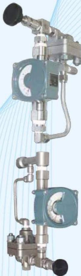
CMA系列吹洗装置是由测量流量的金属管转子流量计、针阀和恒流量调节阀所组成。在恒流量调节阀的自动控制作用下，不管是管路中的入口（一次侧）压力变化还是出口（二次侧）变化，始终能够保持管路中的流体流量为恒定输出，其管路中的流体流量由金属管转子流量计就地指示直接读出。一般应用于要求管路中流体流量恒定输出的场合，与其它仪表配合使用可测量压力、液位、密度等工艺参数，广泛应用于石油、化工、冶金、电子、电力等工业领域。
