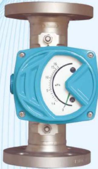
NMX1000系列金属管转子流量计为现场指示仪表，常用于测量液体、气体和蒸汽流量，针对腐蚀性介质还可以提供内衬PTFE材质或其它特殊材质。仪表基本高度为250mm，便于配管设计，互换性强。由于结构简单、维护方便、工作可靠、压力损失小、对直管段基本无要求等优点，被广泛应用于石油、化工、冶金、纺织印染、环保、电力等工业领域。
