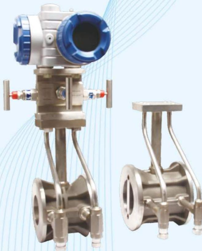
STV系列V锥流量计是一种新型差压式流量计，它由V锥流量传感器、导压附件与差压变送器等组成。V锥流量传感器由同轴安装在测量管内的迎流与背流两个V形体对接构成。流体沿迎流锥形芯体逐渐节流收缩到管道内壁附近，随后沿管道内壁与背流锥形芯体流出，是一种逐渐收缩，逐渐扩散的节流装置，在迎流锥体上游与背流锥体下游之间形成一定的压力差，通过导压附件与差压变送器可以测量此压力之差，从而实现流量测量的功能。
